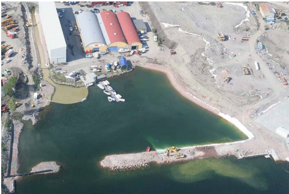
Figur 4.4. Foto som viser arbeid med strandkantdeponi pr august 2005. Arbeid med omlegging av eksisterende løp av Prestebekken pågår. Foto: Tor Kviljo, miljøvernavdelingen.
