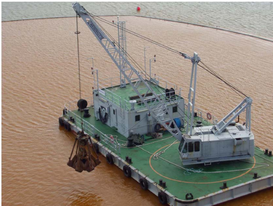
Fig 3.7. foto fra grabbmudring ved industrikai. Kilde: Agder Marine
