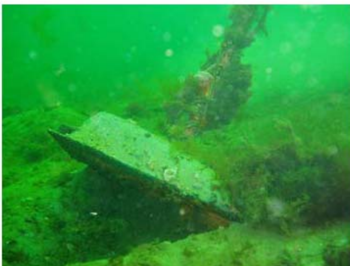
Figur 7.1. Foto av delvis veltet fastmerke. Kilde: NGI
