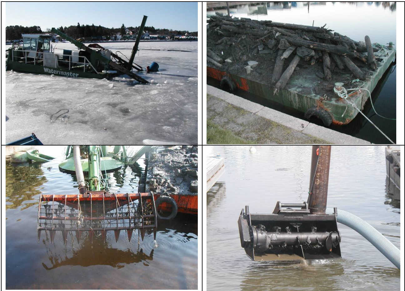
Figur 6.32, fotos som illustrerer problemer med mudrearbeidet. Øverst isproblemer og skrot. Nederst harv som ble benyttet til rydding av sjøbunn, og rotor med kniver som ble benyttet ved sugemudringen. Alle foto: Agder marine.
